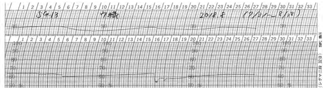
図3 木質庫の温湿度 除湿停止 (2018年8月) (上段=温度, 下段=湿度, 毛髮式温湿度計の記録紙を加工表示)
