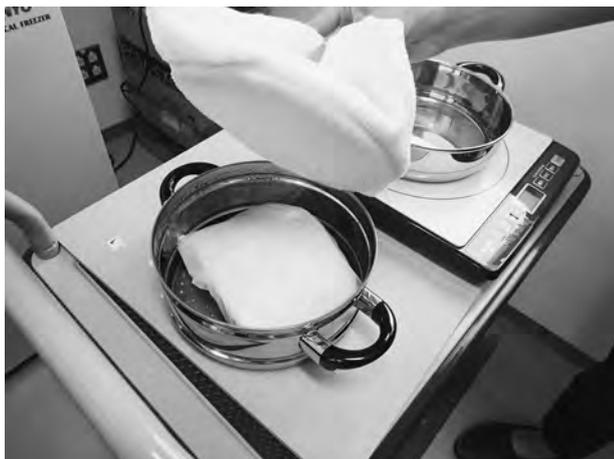
図2 飽和水蒸気加熱脱臭
