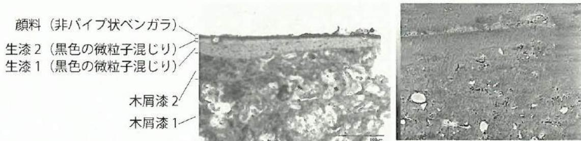
図5 蓋胎漆器2(破片)の塗膜構造 左:透過顕微鏡像、右:反射電子像。
