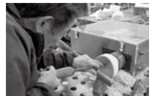
図61 かんな棒とウマを用いた旋削
