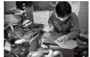
図29 金具師の指導のもと鑿で鉄板を切る
