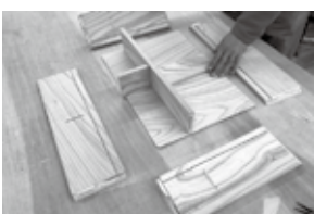
図 27 合板部分を組み立てる
