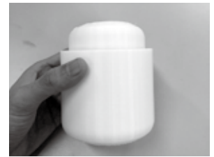
図19 3Dプリンタによる立体サンプル
